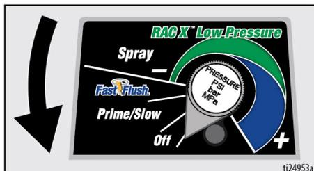
4. Inserire il tubo di drenaggio in un secchio e ruotare la valvola di ricircolo verso il basso per scaricare la pressione. Lasciare la valvola di ricircolo nella posizione di drenaggio (in basso) fino alla successiva operazione di spruzzatura.
